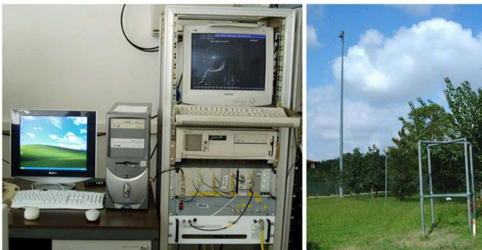
*Osservatorio Ionosferico permanente di Roma equipaggiato con la ionosonda AIS-INGV (Advanced Ionospheric Sounder) (a destra) e sistema di antenne (a sinistra).*
