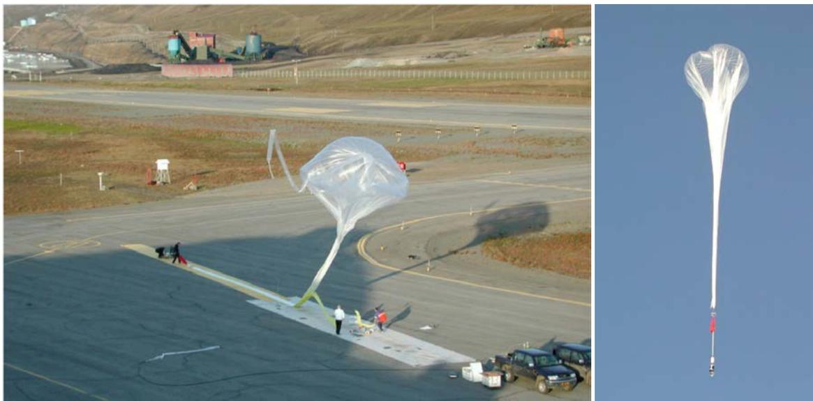
*Nata per lo studio delle anomalie magnetiche a scala continentale la navicella PEGASO (magnetometro con telemetria satellitare) ha detenuto, per l'anno del suo primo volo in stratosfera, il record di permanenza in quota. Collaborazione scientifica internazionale tra INGV, ASI, PNRA, ISTI-CNR, Università degli Studi di Roma "La Sapienza" (Dipartimento di Fisica) e Andoya Rocket Range.*
