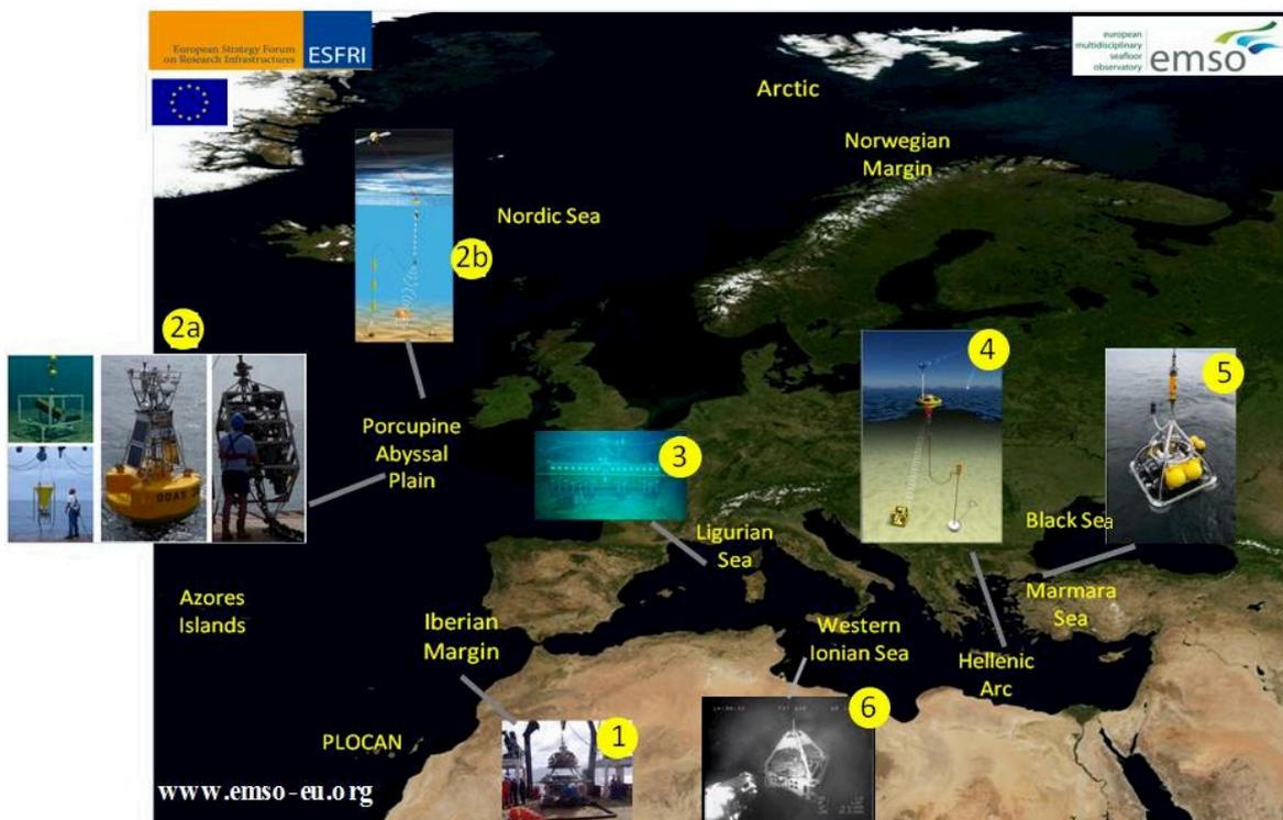
*Osservatori sottomarini utilizzati nei nodi dell'infrastruttura ESFRI EMSO: 1) Margine Iberico: osservatorio GEOSTAR a bordo nave prima di una deposizione; 2a, 2b) Margine Atlantico Nord-Orientale: osservatorio MODOO con trasmissione acustica a boa di superficie; 3) Mar Ligure: junction box dell'osservatorio cablato MEUST; 4) Arco Ellenico: sistema di monitoraggio POSEIDON; 5) Mar di Marmara: modulo multiparametrico SN4; 6) Mar Ionio Occidentale: osservatorio cablato NEMO-SN1.*
