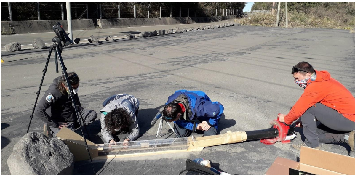
Tunnel del vento portatile realizzato dal Laboratorio HPHT di Roma per la misura della risospensione della cenere vulcanica (vulcano Sakurajima, Giappone).
