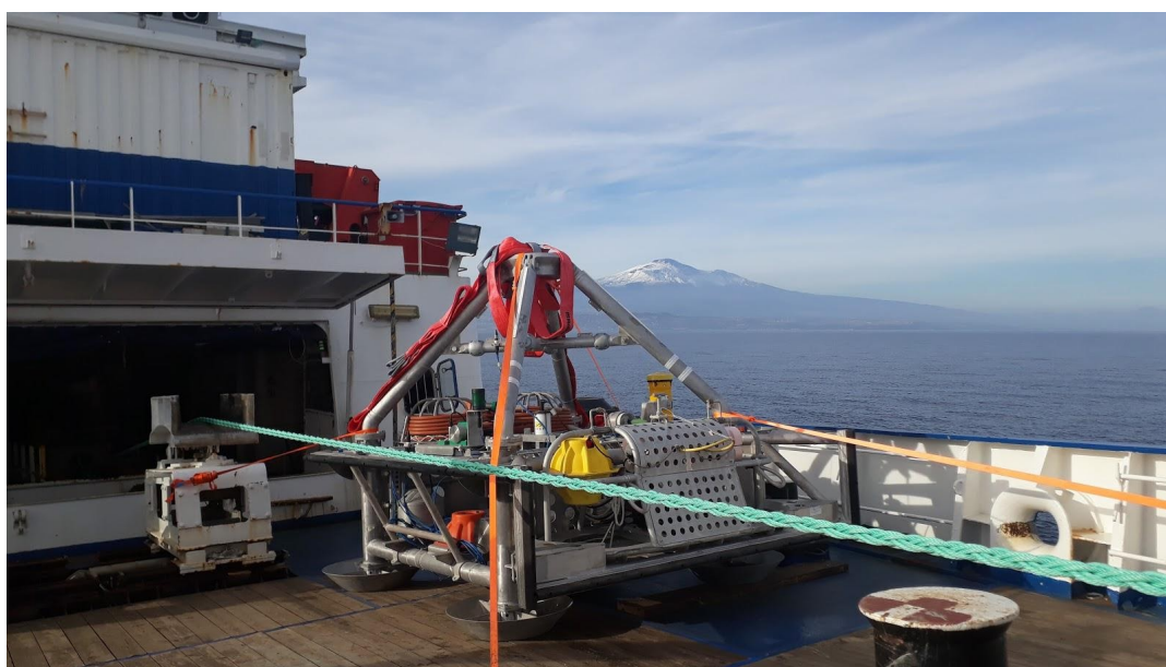
La stazione di monitoraggio multidisciplinare SN-1 dell'osservatorio EMSO Western Ionian Sea a bordo nave nel corso delle operazioni di manutenzione del 2019.
