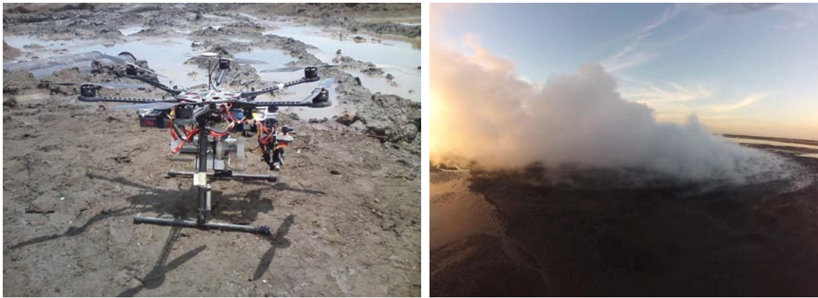
Figura 16.16 A sinistra, Drone S800 con a bordo un rivelatore di gas, pronto al decollo per una missione di volo sul cratere di fango LUSI (Indonesia). A destra, volo sul cratere LUSI.
