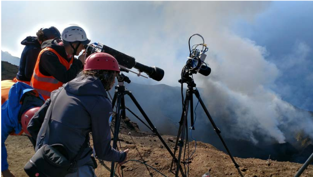
Figura 2. Osservazione dell'attività eruttiva dello Stromboli con telecamere ad alta velocità (foto INGV).
