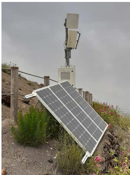
Figura 16.3 Stazione di monitoraggio VCRE, area del Gran Cono, Vesuvio. Foto di M. Orazi.
