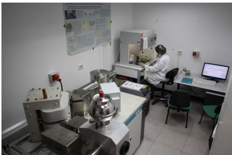
Figura 16.4 Laboratorio di spettrometria di massa. Gli elementi di interesse (Sr, Nd o Li) sono caricati su filamenti di renio per essere analizzati mediante uno spettrometro di massa a ionizzazione termica (ThermoFinnigan Triton TI® Mass Spectrometer). Lo strumento è stato installato in un locale dotato di un sistema di condizionamento che garantisce temperatura costante.
