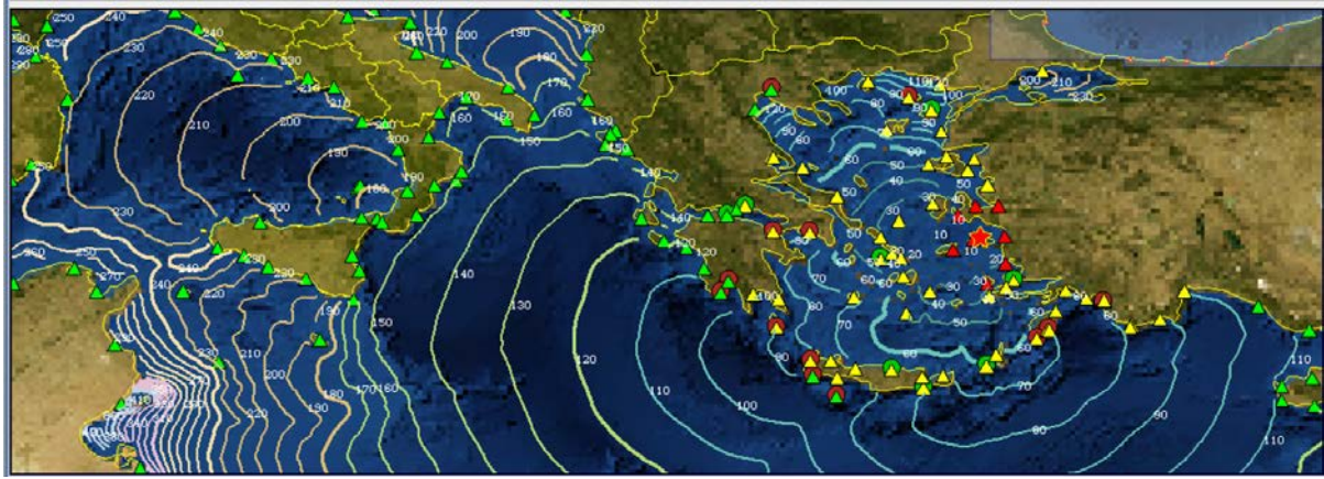
Figura 2.3.6 Schermata di controllo della postazione CAT durante l'allerta (Rossa per Grecia e Turchia, Verde per l'Italia) provocata dal terremoto di magnitudo 7.0 al largo dell'isola di Samos in Grecia, il 30 ottobre 2020 (la stella è l'epicentro). Si notano i Forecast Point rossi in prossimità dell'epicentro. Le linee continue sono le isocrone dello tsunami. Schermata di controllo della postazione CAT durante l'allerta (Rossa per Grecia e Turchia, Verde per l'Italia) provocata dal terremoto di magnitudo 7.0 al largo dell'isola di Samos in Grecia, il 30 ottobre 2020 (la stella è l'epicentro). Si notano i Forecast Point rossi in prossimità dell'epicentro. Le linee continue sono le isocrone dello tsunami.
