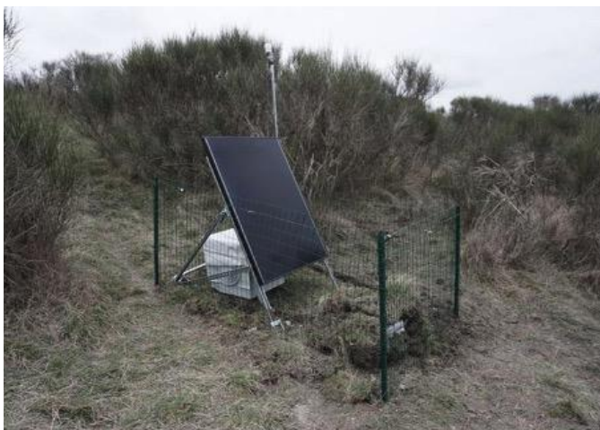
Figura 2.2.5 Esempio di una stazione sismica semipermanente installata in Toscana meridionale, equipaggiata con pannello solare e modem UMTS per la trasmissione dei dati in remoto acquisiti presso il centro di acquisizione dati di Pisa.
